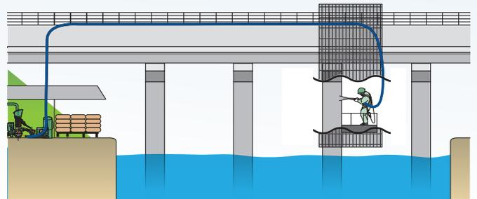
長距離圧送により供用中の橋や床版下面、地下構造物など施工対象付近にプラントが設置できない現場でも施工可能です。
